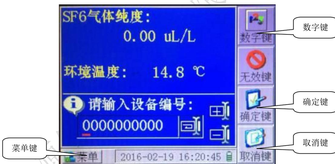
进入“保存界面”后，设备编号的第一位数下的光标在不停闪烁，这样就可以从第一位开始输入数字了，输完第一位按下向右移位键
