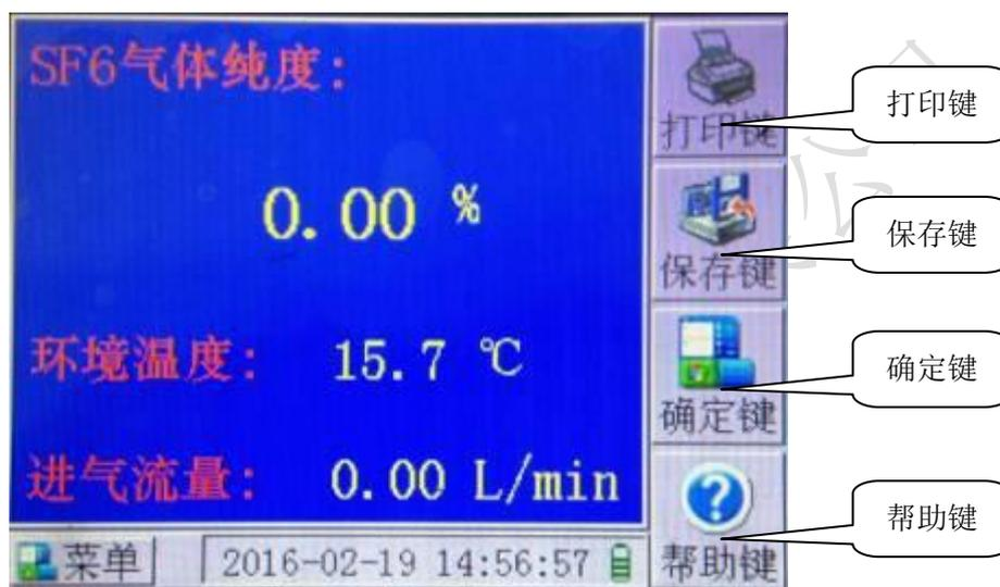
进入“测量界面”后，你可以看到 SF6 气体纯度、环境温度、环境湿度、进气流量、时间日期、电池容量等信息；这时连接好节气管道后，调节流量进气阀，把进气流量调节到 0.2L/min 左右，仪器就进行测量工作。
