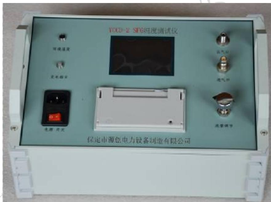
在仪器的面板上有环境温度、充电指示灯、电源插座、电源开关、显示屏、打印机、进气口、出气口、流量调节阀等。
